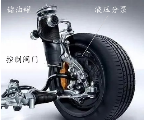
液压悬架工作原理图示
